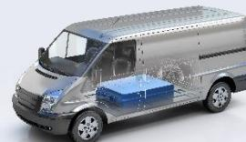
禁止用高压水枪直接冲洗电池；在清洗车辆时，应避开高压元器件，避免与水接触产生不良后果
