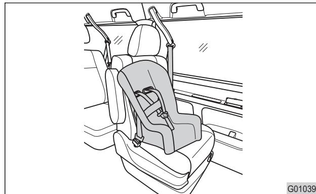
2 将安全带穿过向前式—儿童（可转换）座椅，并将锁片插入锁扣中。
