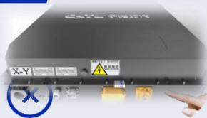
严禁任何时候用双手同时触摸电池箱体的正负极柱
